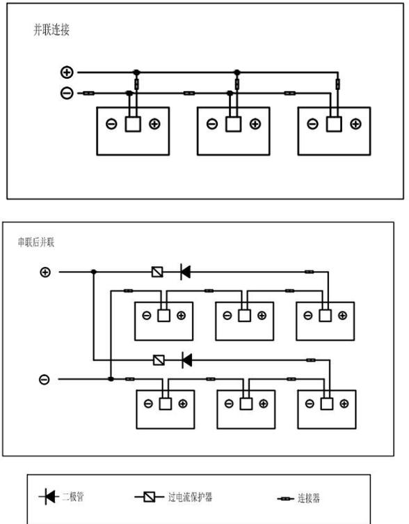
图 11 电联接示意图
