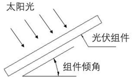
图 1 光伏组件安装倾角示意图
