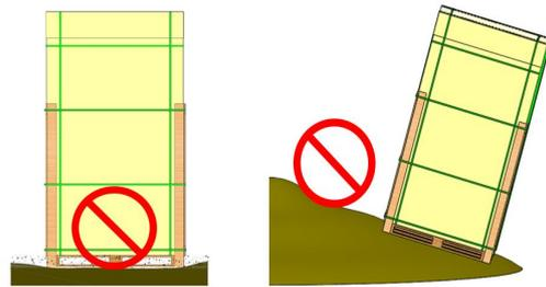
地质松软和有积水处禁止 倾斜坡面 $>4^\circ$ 禁止
