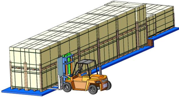
短边立式、U型包装叉车卸货示意图
